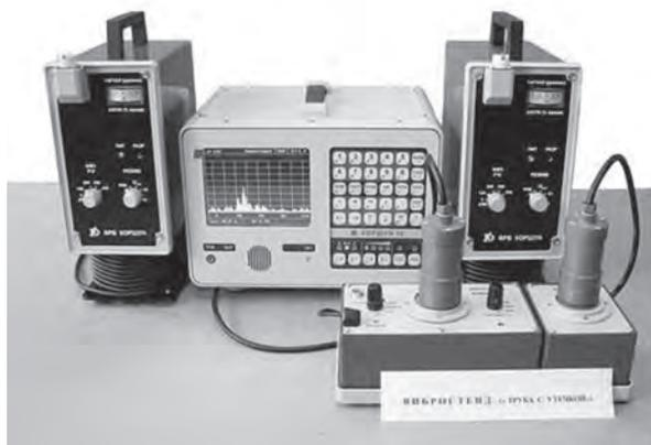
*На фотографии показан прибор КОРШУН-12М вместе с двухканальным вибростендом – «моделью трубопровода с утечкой».*
